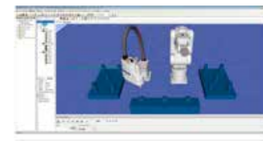
工作单元布局和工作路径编程测试的3D模拟器
